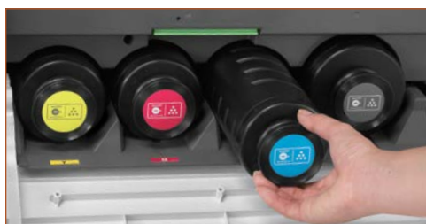
Le remplacement des cartouches de toner peut se faire à la volée, alors même que le traitement des travaux se poursuit, pour maximiser la productivité.
